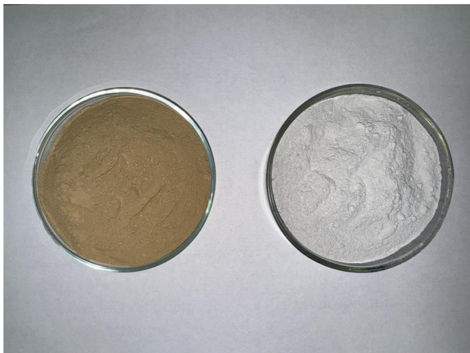
**Рисунок 2 – Полученная очищенная белая сажа (технология получения редких и редкоземельных металлов и белой сажи из руд коры выветривания месторождения Кундыбай)**
